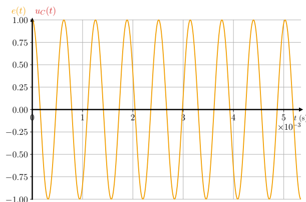
FIGURE E7.4 – u_C(t) du RC sinusoïdal pour \omega \gg \frac{1}{\tau}
