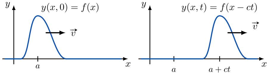
FIGURE ON1.6 – Propagation vers la droite
