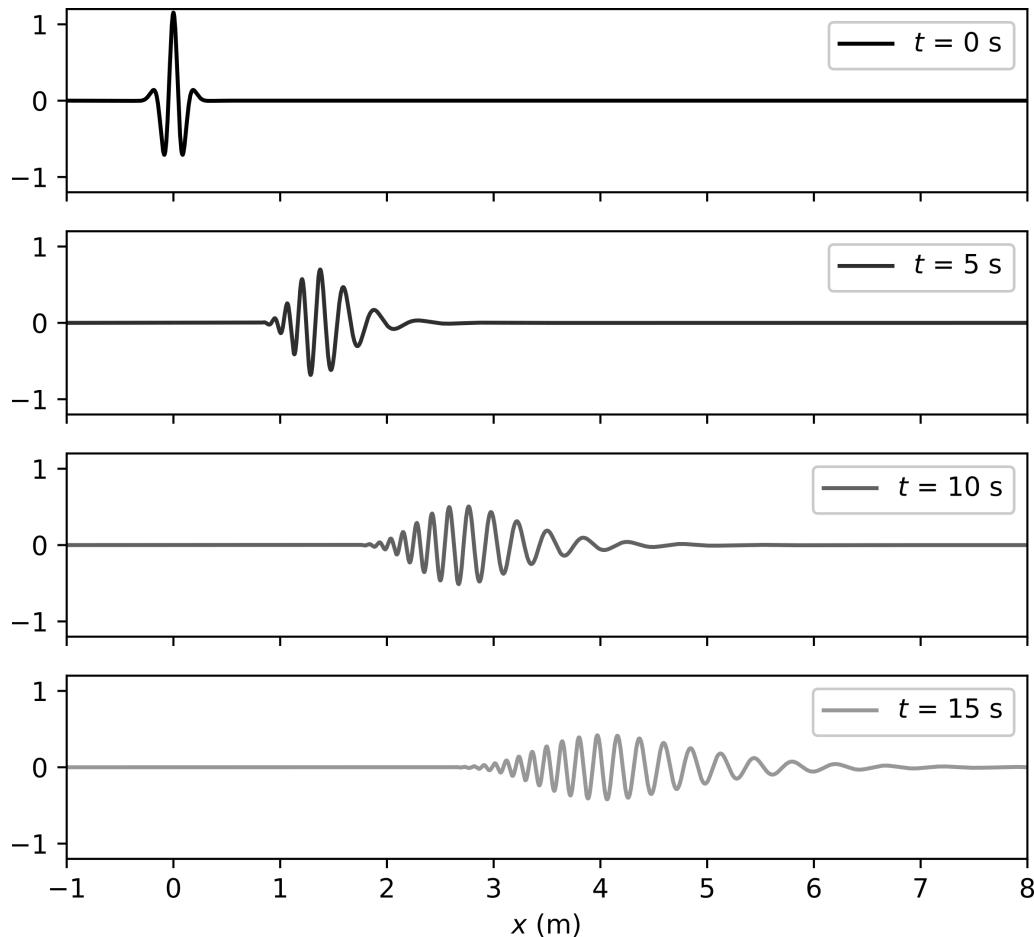
**FIGURE ON1.7** – Propagation dispersive d'une onde à la surface de l'eau. On observe nettement que les composantes sinusoïdales de hautes fréquences se propagent avec une moins grande vitesse que les composantes de basses fréquences. En ordonnée, l'unité de la hauteur d'eau est arbitraire.
