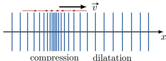
FIGURE ON1.2 – Onde longitudinale.
