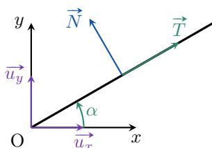
3 Exprimer  $\vec{P}$  et  $\vec{T}$  en fonction de  $m$ ,  $g$ ,  $T$  et  $\theta$  dans la base  $(\vec{u}_r, \vec{u}_\theta)$  d'abord, puis dans la base  $(\vec{u}_x, \vec{u}_y)$ .
