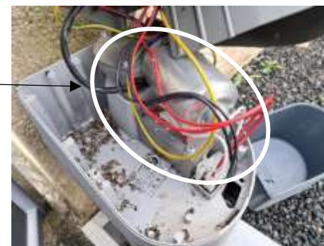
Zoom : moteur électrique et le réducteur à engrenage
