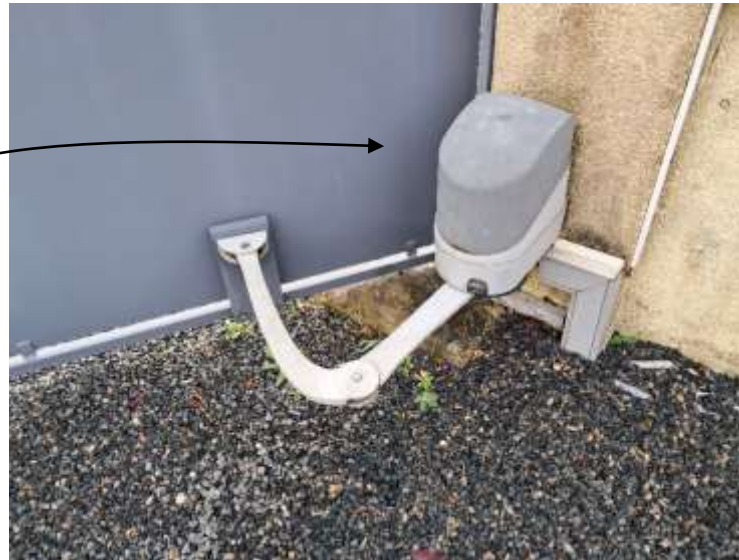
Zoom sur la motorisation d'un vantail : boîtier moteur et bras
