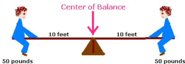
Si une masse est plus massive, G est déplacé vers cette masse. Si on ne change pas le point d'appui, la balance penche vers la masse la plus grande. Pour rétablir l'équilibre, il faut déplacer le point d'appui vers la masse la plus importante, au niveau du barycentre des masses.
