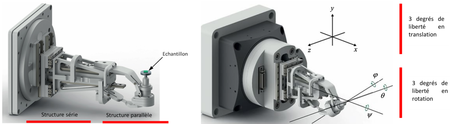
FIGURE 9 – Structure du goniomètre SmarGon et paramétrage des six degrés de liberté de l'échantillon
