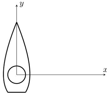
Un bateau est muni d'un cylindre vertical de rayon  $R$  et de hauteur  $h$ , tournant autour d'un axe vertical à la vitesse angulaire  $\vec{\omega} = \omega \vec{e}_z$ . L'air est assimilé à un fluide parfait incompressible et le vent souffle à une vitesse uniforme constante  $\vec{u} = u \vec{e}_x$ .
