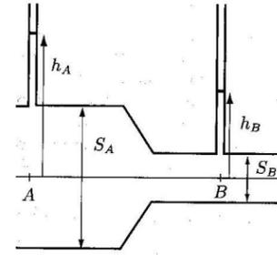
L'écoulement du fluide est supposé parfait stationnaire incompressible et homogène. Il est unidirectionnel sur les sections  $S_A$  et  $S_B$ .
