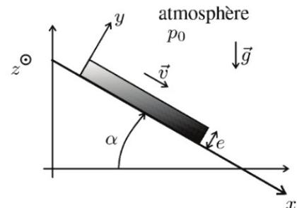
La pression de l'atmosphère au dessus du fluide est uniforme et vaut  $p_0$ , la viscosité de l'air étant négligée.
