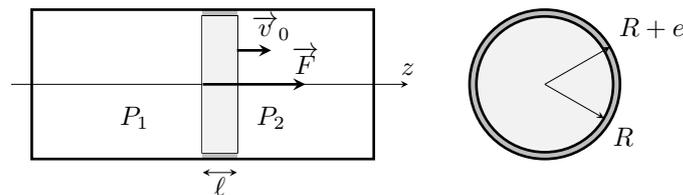
1. (a) On néglige la force de viscosité exercée sur la surface latérale du piston devant les forces pressantes sur ses faces planes. Exprimer la différence de pression entre les deux faces du piston en fonction de  $F$  et des dimensions du piston.
