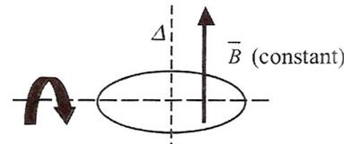
Cas 6 : la spire tourne avec une vitesse angulaire de  $5 \text{ rad.s}^{-1}$  autour d'un de ses diamètres dans un champ magnétique constant et uniforme, parallèle à son axe, de 0,1 T
