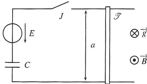
Une tige conductrice  $\mathcal{T}$  glisse sur deux rails horizontaux distants de  $a$ . Elle ferme électriquement un circuit comprenant un interrupteur  $J$ , un condensateur de capacité  $C$  et un générateur de f.é.m. constante  $E$ . la tige  $\mathcal{T}$  a une résistance électrique  $R$  et une masse  $m$ . L'autoinductance du circuit sera négligée.
