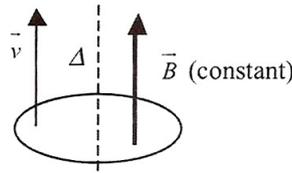
Cas 3 : la spire se déplace sans changer d'orientation avec une vitesse de  $2 \text{ m.s}^{-1}$  parallèle à son axe dans un champ magnétique constant et uniforme de 0,1 T
