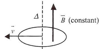
Cas 4 : la spire se déplace sans changer d'orientation avec une vitesse de  $2 \text{ m.s}^{-1}$  orthogonale à son axe dans un champ magnétique constant et uniforme de 0,1 T
