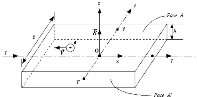
1. Le courant électrique est assuré par le déplacement d'électrons de charge  $-e$ , se déplaçant à la vitesse  $\vec{V} = -V\vec{u}_x$ , ce qui revient au même que le déplacement de particules chargées  $+e$  selon  $+V\vec{u}_x$ .
