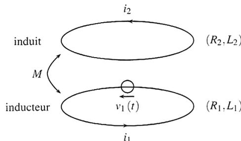
1. Écrire les équations électriques relatives aux deux circuits (équations de couplage entre  $i_1$  et  $i_2$ ).
