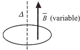
Cas 1 : La spire est immobile dans un champ magnétique uniforme parallèle à son axe d'amplitude 0,1 T et de fréquence 50 Hz
