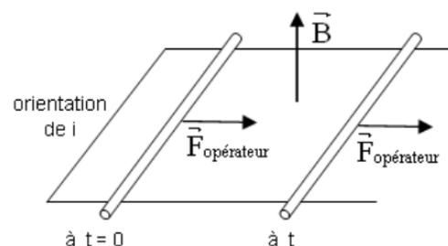
1. Le circuit étant orienté arbitrairement, représenter la force électromotrice induite  $e(t)$  et déterminer son expression en fonction de la vitesse  $v(t)$ . Quel est le signe de  $e(t)$  ?
