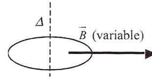
Cas 2 : la spire est immobile dans un champ magnétique uniforme orthogonal à son axe d'amplitude 0,1 T et de fréquence 50 Hz
