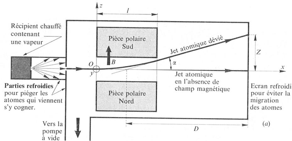
Figure 2 : Configuration de l'expérience de STERN et GERLACH
