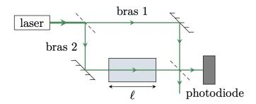
Une cuve fermée de longueur  $\ell=10,0$  cm est placée dans l'un des bras. Cette cuve contient initialement de l'air, d'indice optique  $n_{\rm air}$ , progressivement remplacé par du méthane d'indice  $n_{\rm m}>n_{\rm air}$ . Au cours de l'opération, la photodiode permet d'observer le défilement de 32 franges.
