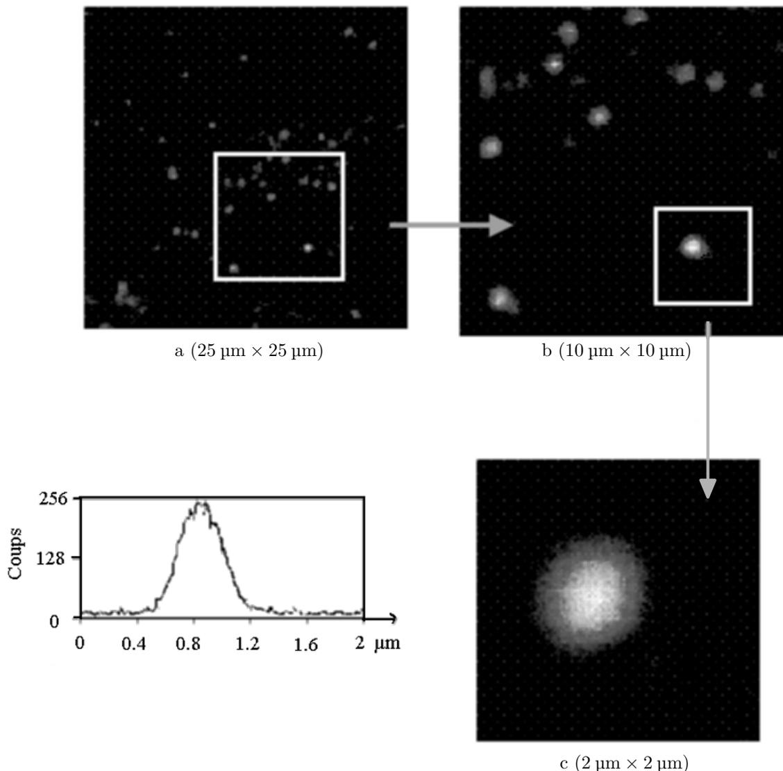
**Figure 3** Images de fluorescence de molécules individuelles (256  $\times$  256 pixels), zooms successifs sur une même zone de l'échantillon (images a, b et c) et profil du nombre de coups détectés sur une ligne de l'image c passant par le centre de la tache image
