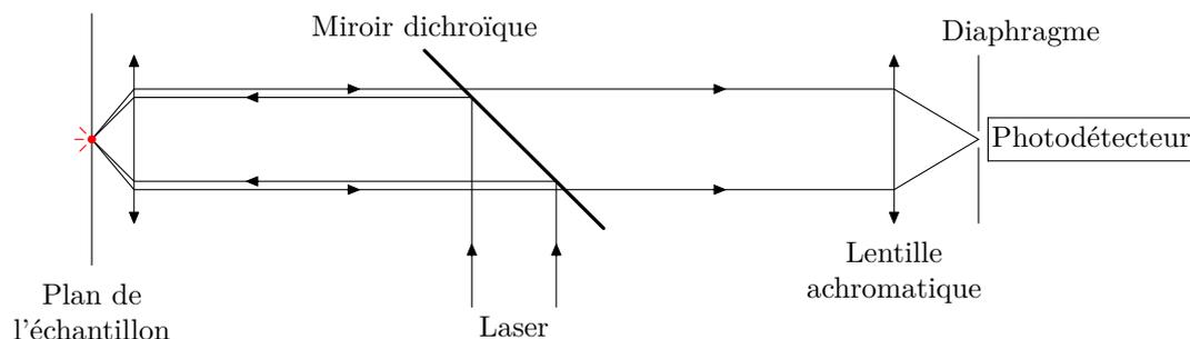
**Figure 2** Schéma de principe du microscope confocal
