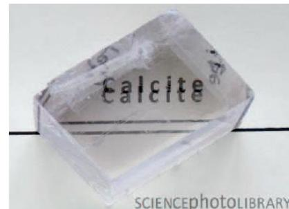
La calcite est un matériau biréfringent, c'est-à-dire qu'il est caractérisé par deux indices optiques (créant les deux rayons) valant 1,658 et 1,550. Une réflexion totale interne intervient au niveau de la jonction : un des rayons est complètement réfléchi, l'autre est complètement transmis.
