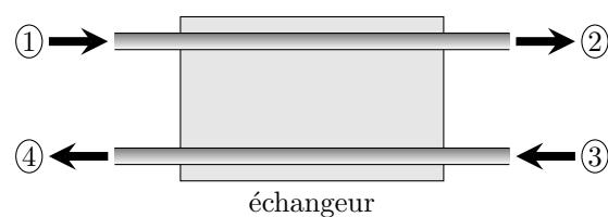
On considère un échangeur thermique parcouru par deux circulations d'eau à contre courant. On suppose l'échangeur parfaitement calorifugé et les écoulements isobares et en régime permanent. On suppose que la capacité thermique à
