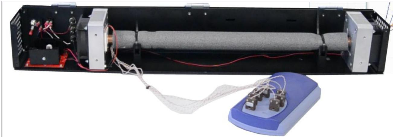
Ce dispositif est constitué d'une barre de cuivre d'une longueur d'une cinquantaine de centimètre. Celle-ci est calorifugée latéralement, afin de diminuer au maximum les fuites thermiques radiales le long de la barre. Un module Peltier permet, par effet thermoélectrique (création d'un transfert thermique par le biais d'un phénomène électrique), d'imposer un flux thermique à l'une des extrémités de la barre grâce à la circulation d'un courant électrique dans le module.
