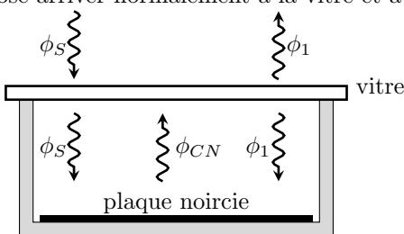
1. On suppose l'équilibre radiatif de la plaque et de la vitre. Écrire les équations exprimant ces équilibres et en déduire la température  $T$  de la plaque.
