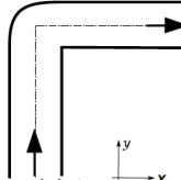
Une tube de section circulaire, coudée à angle droit, est située dans un plan horizontal. De l'eau de masse volumique  $\rho$  s'écoule en régime stationnaire dans ce tube avec un débit massique  $D_m$  (l'eau sort par le côté droit du tube sur le dessin). On néglige la pesanteur et l'écoulement est supposé parfait incompressible.
