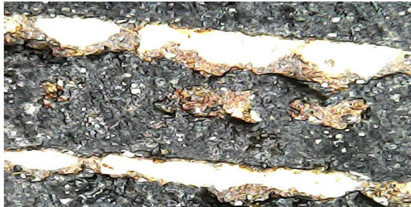
Fig. 17 : Usure du revêtement anti-adhésif d'une poêle
