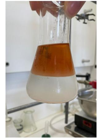
Fig. 13 : Produit de l'amidification sur Fenton
