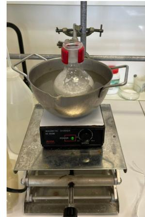
Fig. 12 : Réaction de Fenton sur PTFE
