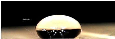
Fig. 1 : goutte sur téflon
