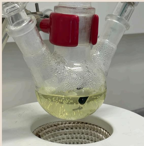
Figure 16- Milieu réactionnel et montage à reflux réalisé
