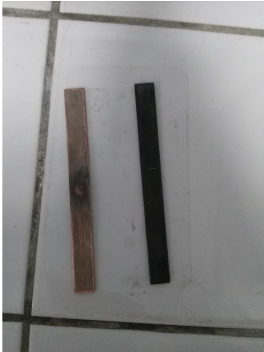
Fig 26: Augmentation de l'hydrophilie de plaques de Zinc et de Cuivre à l'aide d'un traitement par Nitrate d'Argent
