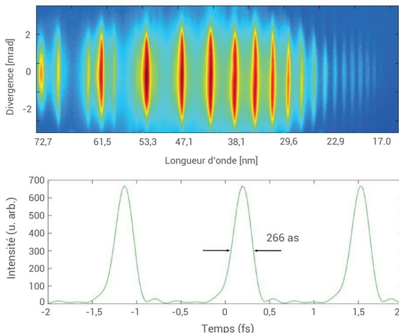
III.3. Émission de flashes attosecondes de rayonnement UVX. (a) Spectre des harmoniques 11 à 47 générées en focalisant un laser Ti : Sa à un éclairement de  $2 \cdot 10^{14} \text{ W cm}^{-2}$  dans un gaz d'argon sur l'installation ATTOLab [28]. (b) Train d'impulsions de 266 as correspondant à la gamme spectrale couvrant les harmoniques 13 à 23.
