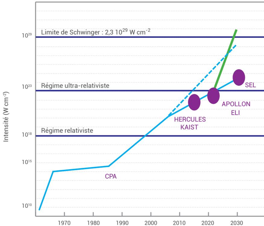
**III.5. La route vers les très hautes intensités depuis les premiers lasers des années 1960.** Intensités laser avant et après le CPA (en bleu) et projection pour des faisceaux X focalisés ultra-intenses (en vert). HERCULES (États-Unis, 0,3 PW) et KAIST (Corée, 3 PW) sont des installations opérationnelles, APOLLON (France) et ELI (Europe) visent les 10 PW, et SEL (Chine) est un projet à 100 PW.
