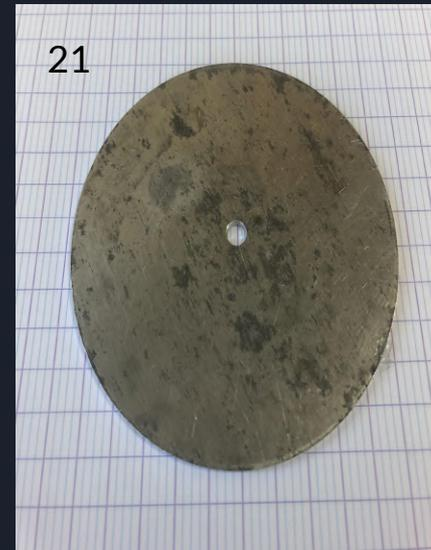
Disque en aluminium de diamètre 10 cm et épaisseur 8mm
