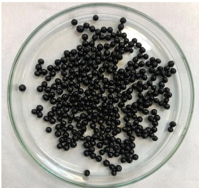
Grosses billes d'alginate avec ferrofluide encapsulé :
