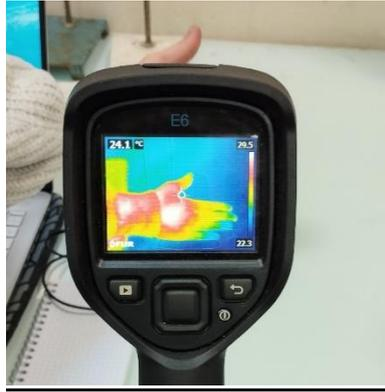
**Figure 5 : Caméra thermique**
