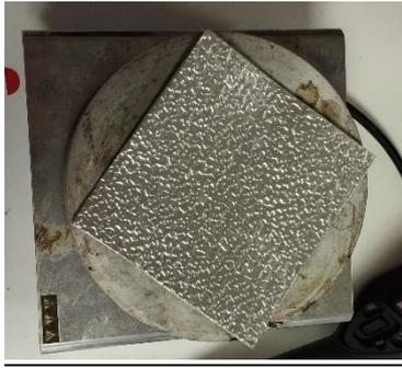
**Figure 19** : Surface rugueuse en aluminium utilisée
