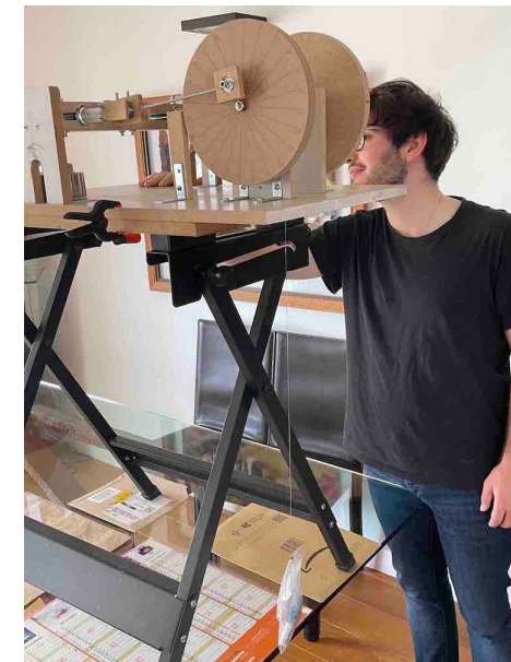
Fig. 11 et 12 : Montage pour mesurer la puissance du moteur (poulie avec charge variable)
