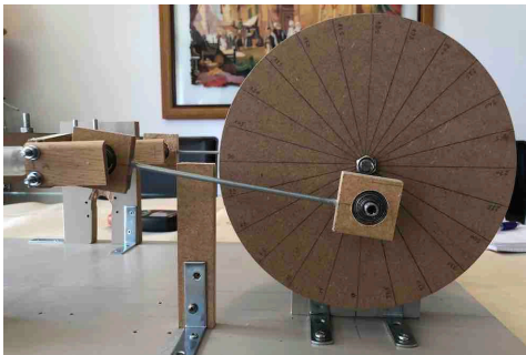
Fig. 21 : Volant calibré pour la mesure des angles
