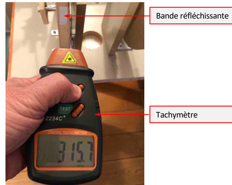
Fig. 10 : Mesure de la vitesse de rotation des volants
