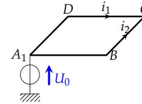
Les courants  $i_1(x)$  et  $i_2(x)$ , issus du générateur et de la loi des nœuds en  $A_1$ , diminuent tous les deux le long de la clôture jusqu'en C et s'y annulent.
