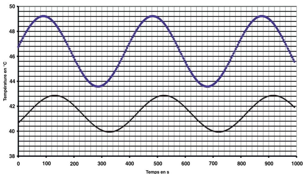
Figure 2 : températures en deux points de la barre
