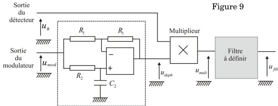
IV.C.1) Montrer que le bloc (entouré en pointillés) construit autour de l'amplificateur opérationnel fonctionnant en régime linéaire permet de déphaser le signal  $u_{mod}(t)$ . Montrer que  $u_{deph}(t)$  et  $u_{mod}(t)$  sont en quadrature de phase à condition d'imposer une relation, supposée vérifiée par la suite, liant  $R_2$ ,  $C_2$  et  $\omega$ .
