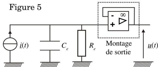
$R_e = 24 \cdot 10^9 \Omega$  est associé en parallèle au film pyroélectrique. Un montage de sortie construit autour d'un amplificateur opérationnel idéal complète l'ensemble.
