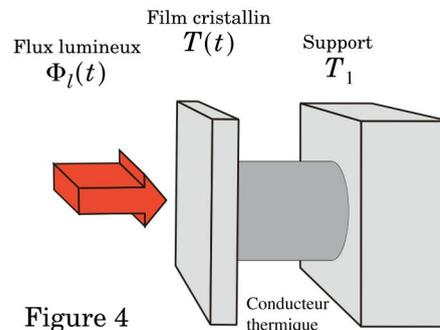
III.B.1) On suppose que la température dans le film cristallin est uniforme. On la note  $T(t)$ . Montrer que cela nécessite que l'épaisseur du film soit faible devant une longueur caractéristique à déterminer.
