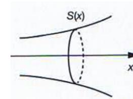
D'autre part, l'écoulement étant parfait, les particules de fluide évoluent de manière isentropique. Dans le cas d'un gaz parfait de coefficient  $\gamma$  constant, cela permet d'écrire la loi de Laplace, de telle sorte que :
