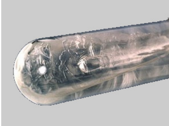
Figure 1 Appareil à point triple de l'eau
