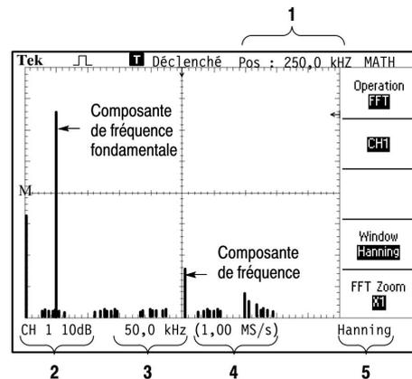
1. Fréquence au niveau de la ligne centrale du réticule
