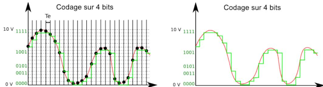
Sur les oscilloscopes on utilise 8 bits, soit  $2^8 = 256$  niveaux possibles, pour améliorer la précision du signal numérique. Lorsque l'on cherche à faire une mesure à partir de l'image numérique du signal observée sur l'oscillo, on veillera à dilater au maximum la courbe en amplitude, afin d'utiliser le maximum de l'écran et donc de bits possibles.
