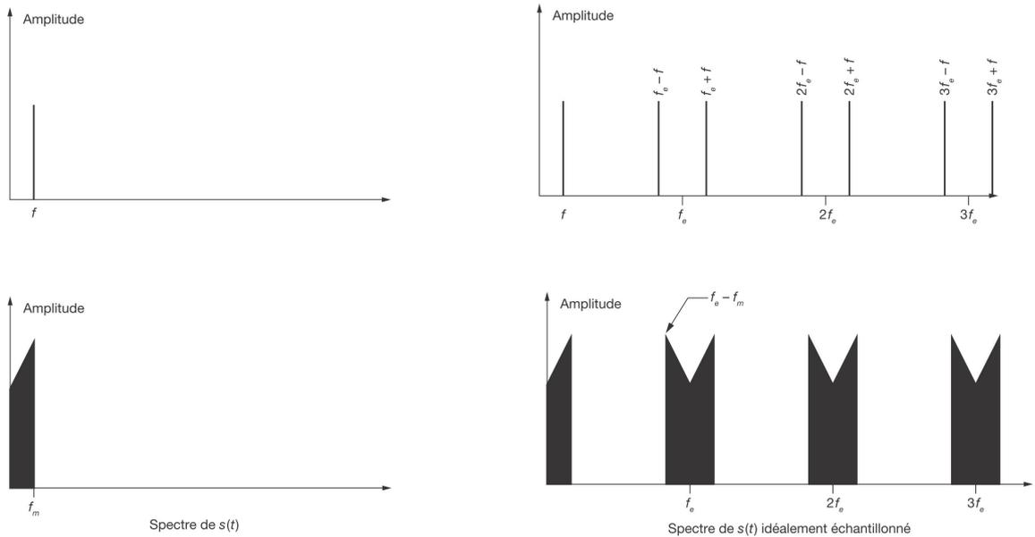
On constate, d'une part, que l'échantillonnage conduit à un **enrichissement périodique** du spectre à des fréquences  $kf_e \pm f_m$  (on parle d'**aliasing** en anglais).
