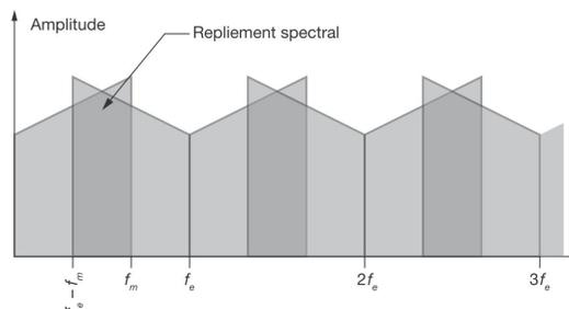
Il est alors impossible de séparer les fréquences initiales de  $s$ , de celles liées à l'échantillonnage, et donc de les récupérer !
