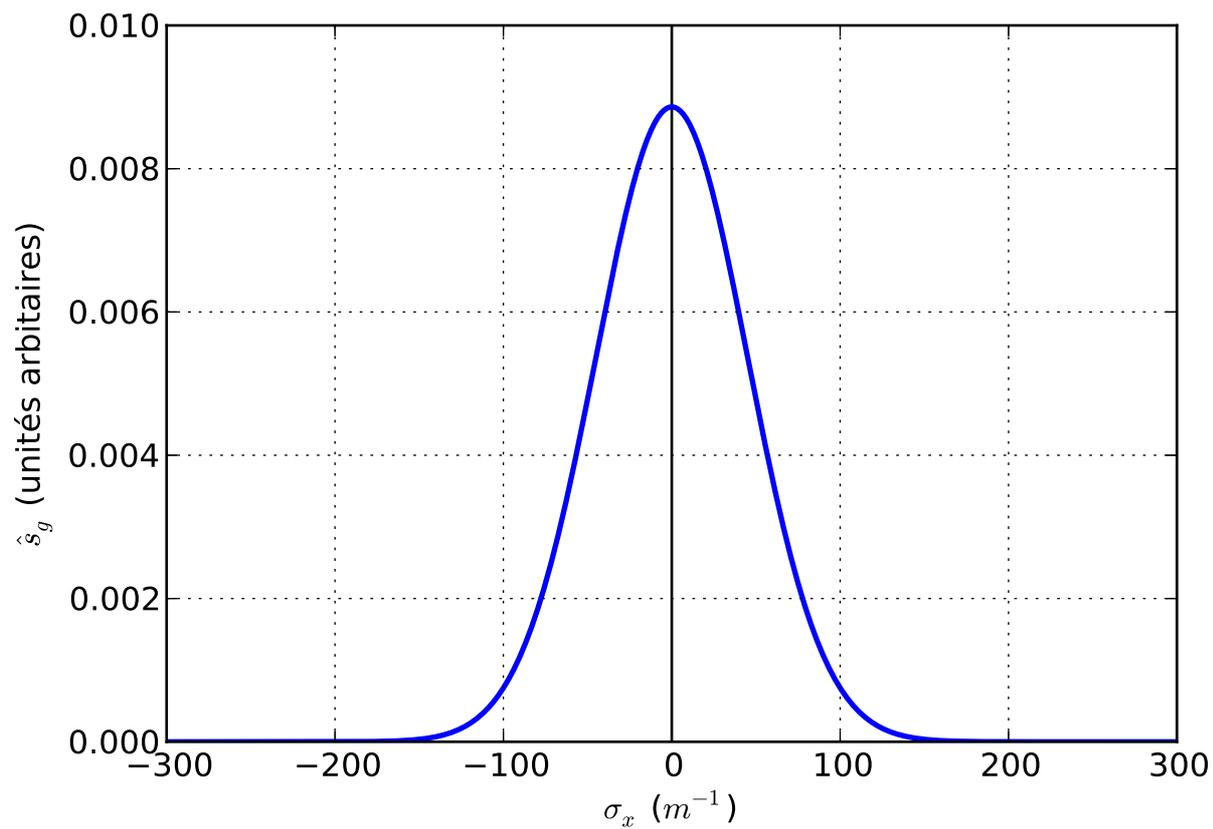
FIGURE 4 – Spectre spatial du scalaire optique gaussien défini au col d’un faisceau laser idéal.
