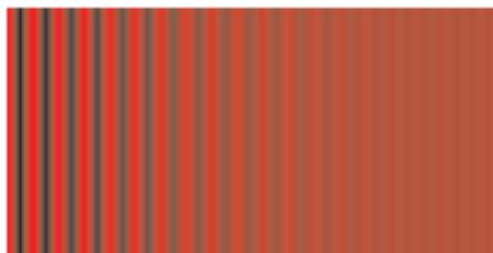
Figure – Allure des franges pour une source rouge de largeur spectrale 25 nm
