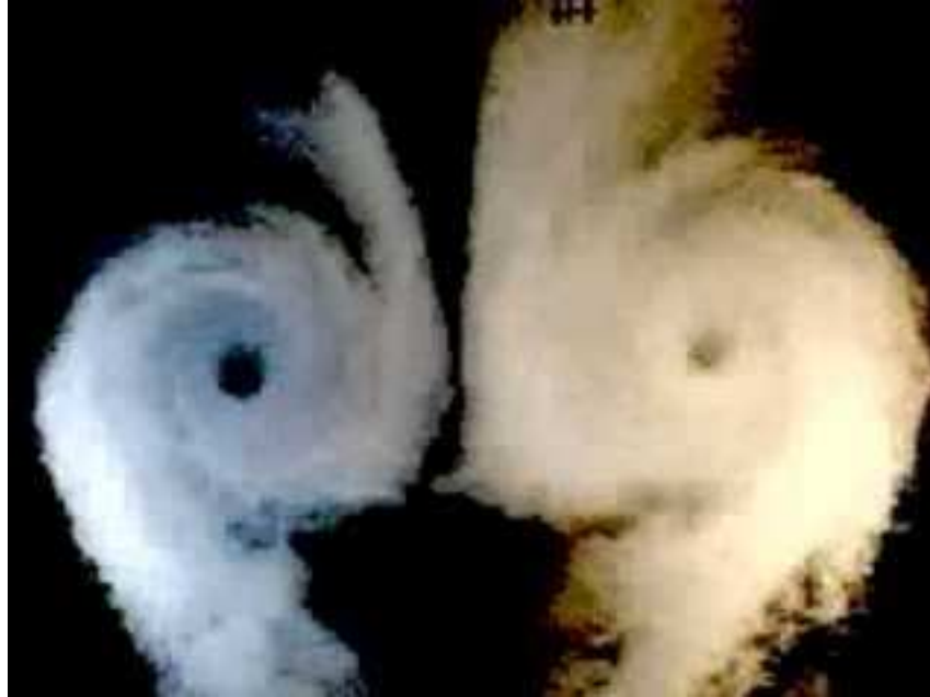
FIGURE 8 – Tourbillon marginal au bord d'une aile d'avion
