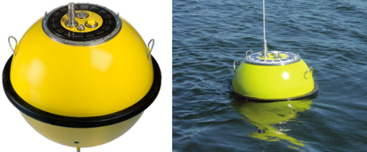
FIGURE 7 – Photographies de bouées houlographes Waverider
