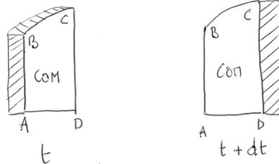
l'instant  $t$ , la quantité de mouvement du système considéré comprend celle de la zone commune et celle  $dP(x')$  de la portion qui entre par la face  $AB$ . À l'instant  $t + dt$ , elle comprend celle de la partie commune et celle  $dP(x')$  de la portion qui est sortie par la face  $CD$ . En projection sur  $\vec{u}'_x$ , la variation de quantité de mouvement pendant  $dt$  s'écrit donc :
