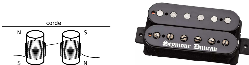
FIGURE 12 – À gauche : principe d'un « micro » à double bobinage. À droite : photographie d'un humbucker pour 6 cordes.
