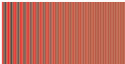
FIGURE 7 – Figure d’interférence obtenue avec une source rouge de profil spectral de largeur 25 nm
