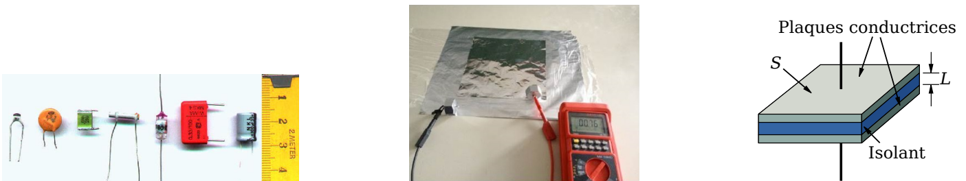
FIGURE 2 – (a) Différents modèles de condensateurs. (b) Condensateur artisanal (exp. de cours) : film plastique entre deux feuilles d'al. (c) Modèle du condensateur plan.
