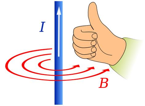
ex : Exemples des lignes de champ d'un câble infini. Illustration de la circulation dépendant des sources enlacées.
