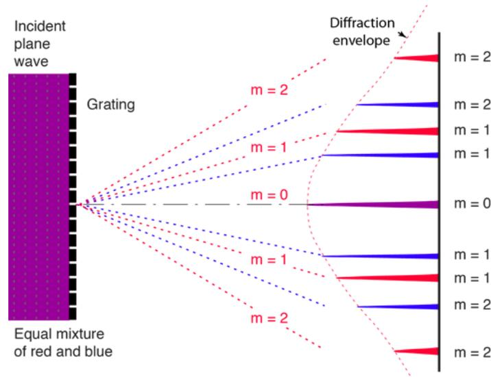
FIGURE 5 – Limitation du nombre de pics visibles par la largeur finie des fentes.
