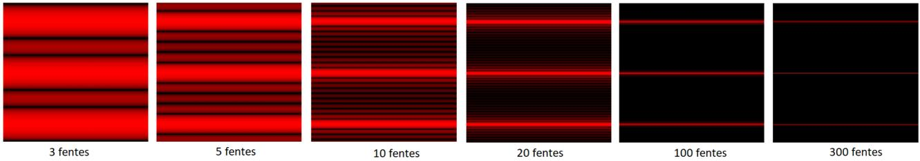
FIGURE 3 – Simulation étudiant l’influence du nombre  $N$  de fentes sur la figure d’interférence.
