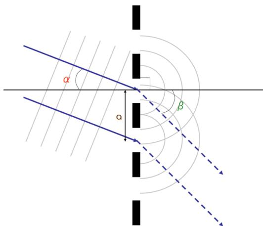
FIGURE 1 – Réseau de diffraction en transmission constitué de  $N$  fentes.
