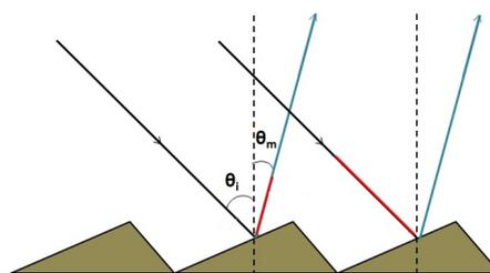
FIGURE 2 – Réseau de diffraction en réflexion, constitué de  $N$  miroirs parallèles non coplanaires.
