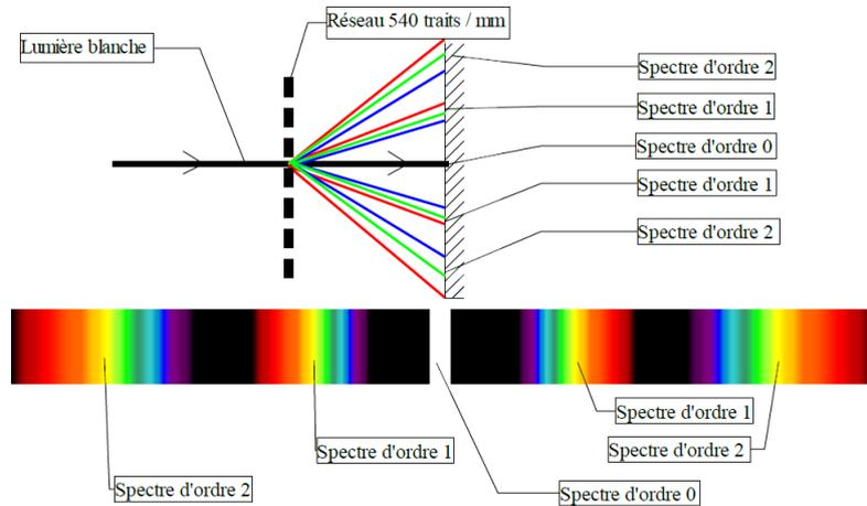
FIGURE 4 – Un réseau de diffraction sépare les composantes de la lumière. En effet, le rouge est plus diffracté que le bleu.
