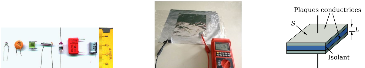
FIGURE 2 – (a) Différents modèles de condensateurs. (b) Condensateur artisanal (exp. de cours) : film plastique entre deux feuilles d'al. (c) Modèle du condensateur plan.
