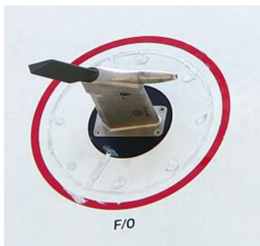
FIGURE 3 – Sonde Pitot sur Airbus A380. L'embouchure est à droite.
