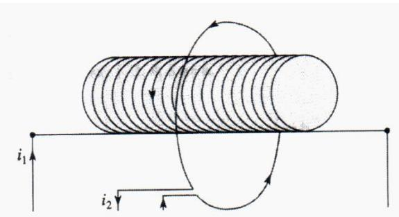
1. Calculer l'inductance mutuelle de ces deux circuits avec les orientations du schéma ci-dessus.
