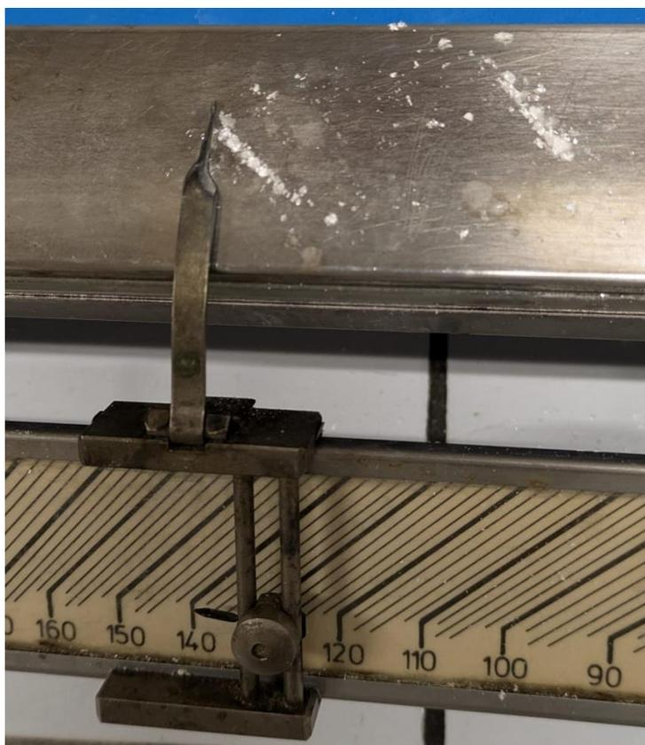
$T_{fus} = 140\text{ }^{\circ}\text{C} \pm 2\text{ }^{\circ}\text{C}$
