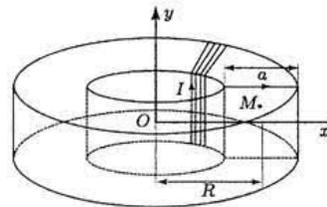
1. Déterminer le champ magnétostatique généré par la distribution de courant à l'extérieur du tore.
