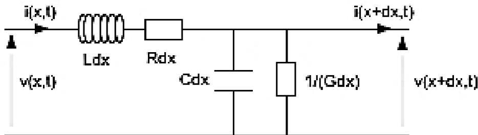
Une ligne de transmission (ou ligne bifilaire) est formée de deux conducteurs séparés par un isolant. Une tranche comprise entre  $x$  et  $x + dx$  est modélisée comme indiquée sur la figure par une résistance  $Rdx$ , une inductance  $Ldx$ , une capacité  $Cdx$  et une conductance  $Gdx$ . ( $R, L, C$  et  $G$  sont des grandeurs linéiques).
