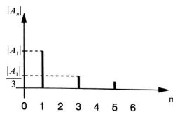
Cela signifie que l'on peut à l'inverse reconstruire le créneau en sommant des fonctions sinusoïdales de pulsations  $\omega$ ,  $2\omega$ ,  $3\omega$ ,  $4\omega$ , ... avec des amplitudes correspondant aux différents  $A_n$ .
