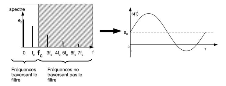
Si l'on veut couper la composante continue tout en laissant passer la fréquence  $f_0$ , on peut alors utiliser un filtre passe-bande dont la fréquence centrale est en  $f_0$  mais dont les fréquences de coupure sont situées entre 0 et  $f_0$  pour la première, entre  $f_0$  et  $3f_0$  pour la deuxième.
