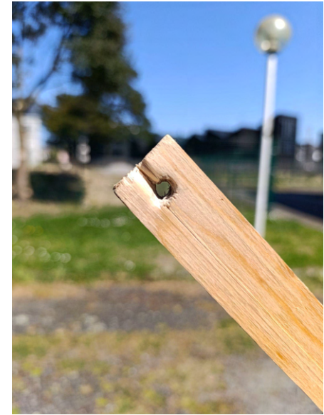
rupture du point d'attache du contrepoids sur le premier trébuchet
