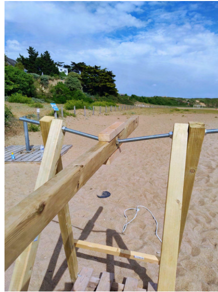
tige du deuxième trébuchet pliée par le contrepoids
