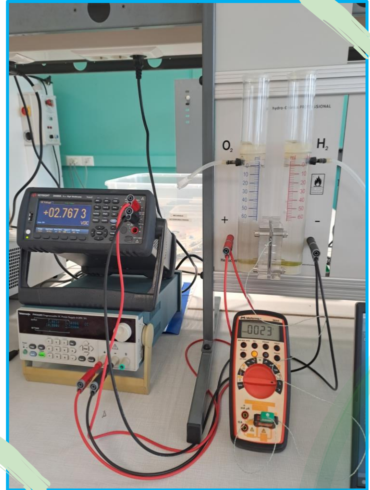
Electrolyseur ancien, multimètre (tension), alimentation
