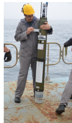
FIGURE 3 – Flotteur Argo juste avant son déploiement en mer par l'Ifremer. (K. Balem/RREX/Ifremer)
