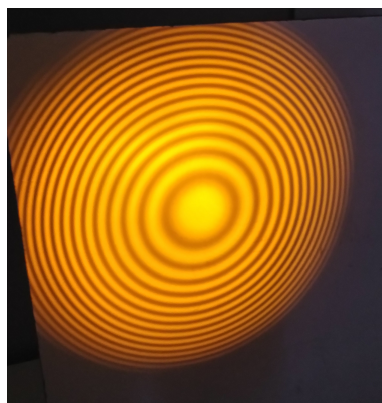
FIGURE 2 – Anneaux avec la lampe à vapeur de sodium
